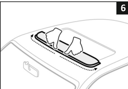
Con el deflector para techo solar en su posición final, retire la cinta adhesiva y retire cuidadosamente el revestimiento protector restante tirando de los extremos. No rompa el revestimiento protector.
