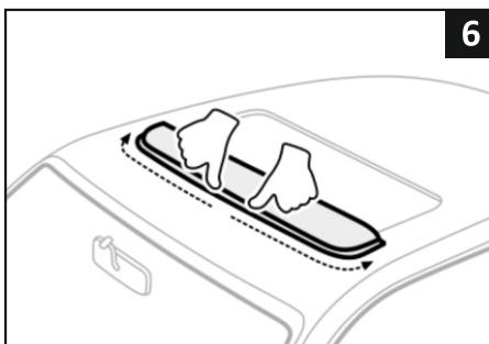
При окончательном положении дефлектора люка на крыше, снимите маклярную ленту и аккуратно удалите оставшийся защитный лайнер, потянув за свободные концы. Не допускайте обрыва защитного лайнера.
