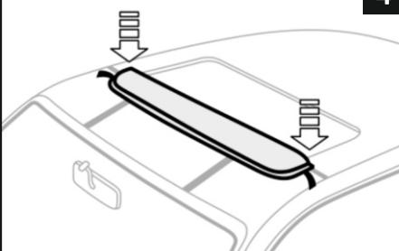
En cada extremo del deflector para techo solar, despegue 5 cm (2 pulgadas) del revestimiento protector de la cinta adhesiva. Durante la instalación, ¡no toque la superficie adhesiva de la cinta con las manos!
