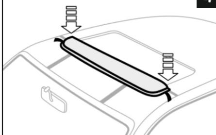
С каждого конца дефлектора люка отогните 2 дюйма (5 см) защитного лайнера с kleящей ленты. При установке не касайтесь руками клейкой поверхности ленты!
